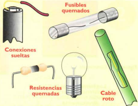
Figura 2.9. Causas de un circuito abierto
